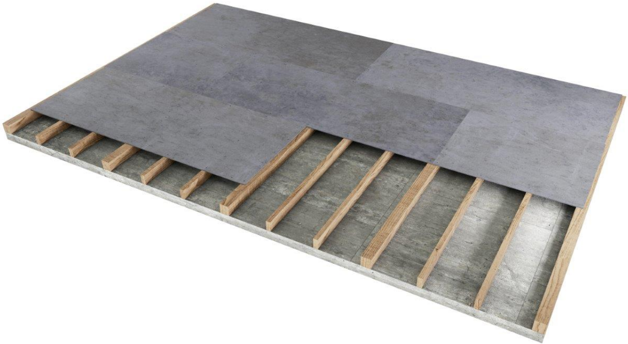
Figure 4.1 - Sol Viroc soutenu par des poutres
