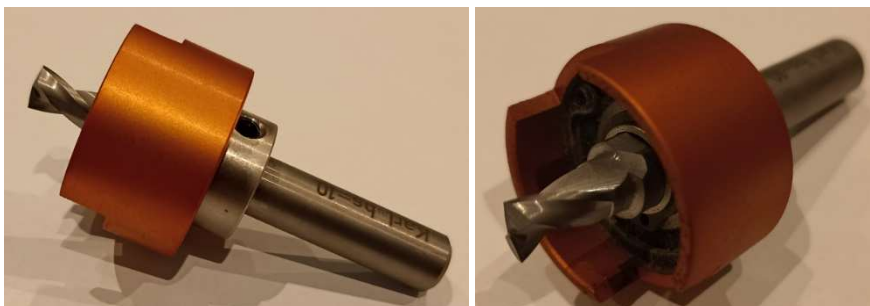
Figure 2.2.18 - Trou d'obturation du système KARL
