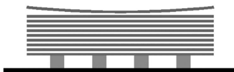
Figure 1.15 - Déformation du panneau supérieur
