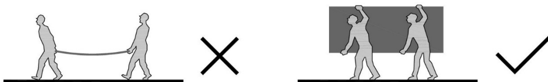
Figura 1.14 – Manuseamento dos painéis Viroc
