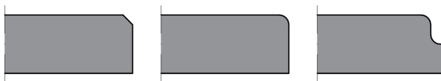
Figura 1.10 – Bisel, boleamento e entalhe.
